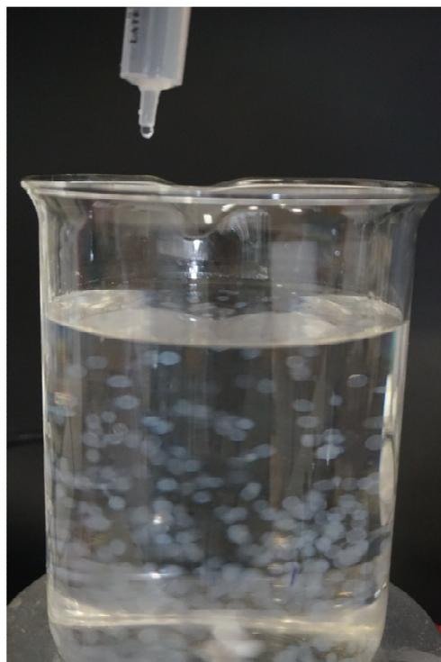
Figura: Processo de obtenção de esferas de alginato de cálcio com as leveduras no seu interior.
