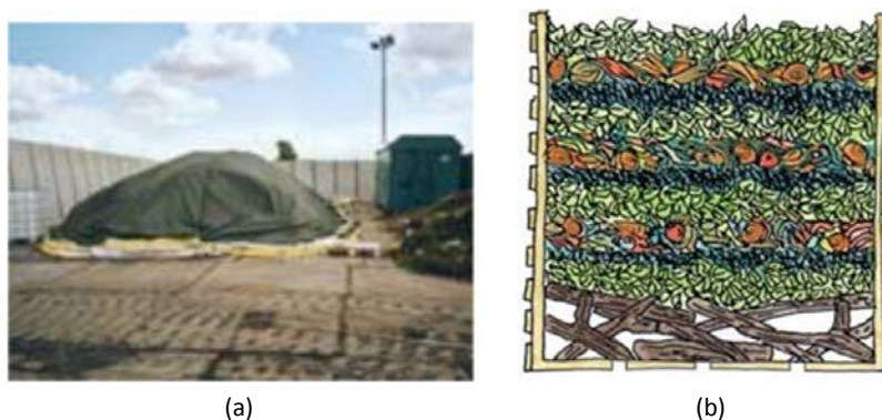
Fig. 1. (a) Pilha de compostagem, coberta com uma membrana respirável; (b) pilhas de compostagem passivamente ventiladas, com a pilha em cima de uma cama de lascas de madeira
