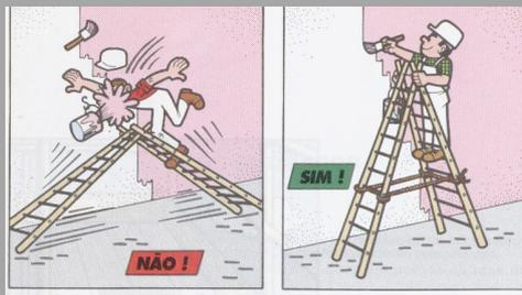
“ As Escadas de tesoura, devem estar bem colocadas para evitar que os seus elementos se abram.
